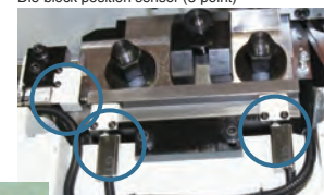
ダイブロック位置センサ (3点) Die-block position sensor (3-point)
