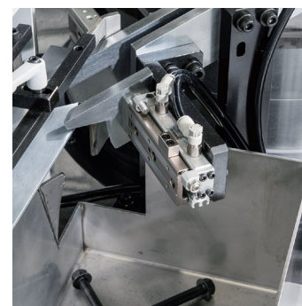
エラーワーク自動排出機構 Error workpiece automatic discharge mechanism
